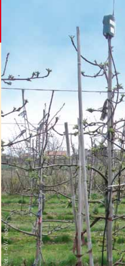
Fot. 6. Wodomierz podłączony do transmitera przesyłającego dane drogą radiową do odbiornika stacji IrriWise
